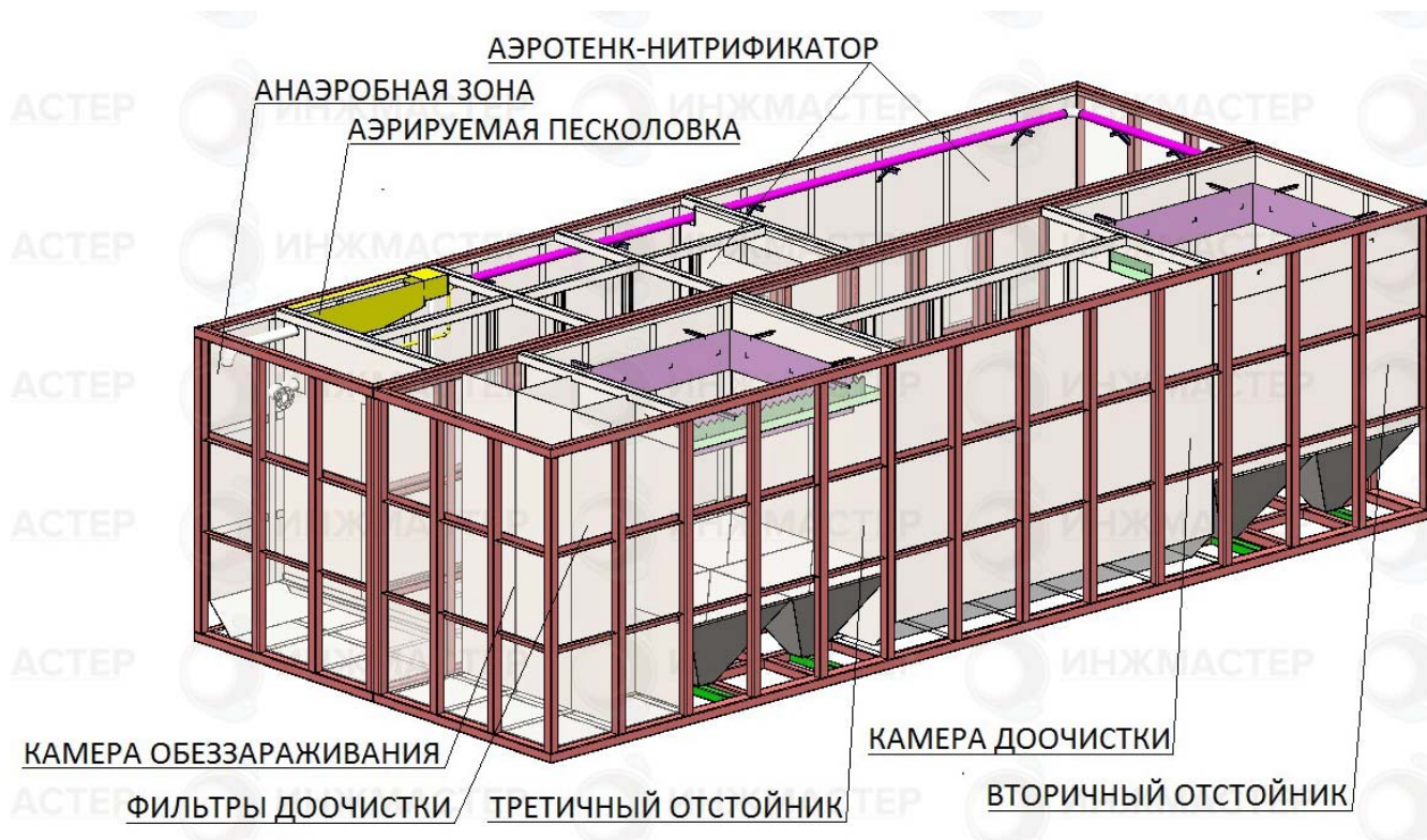
Рисунок 4.2 – Строение блочных очистных сооружений
